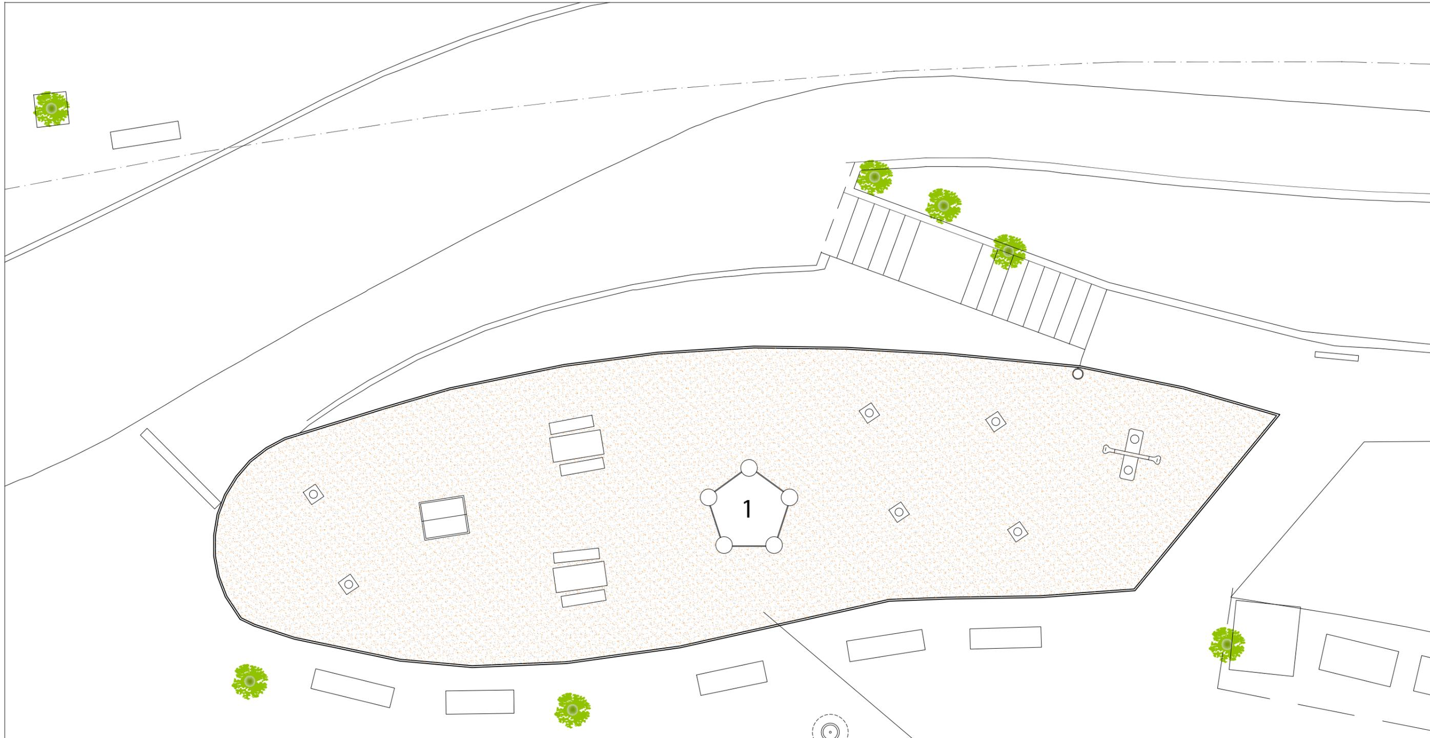
**SUELO DE CAUCHO.** Espesor necesario por seguridad + 2cm para desgaste
